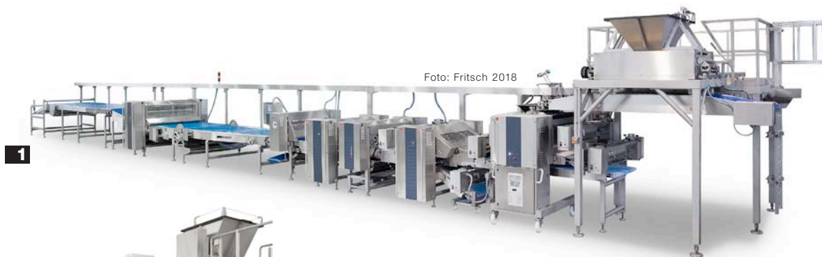
1 Die Impresa Bread hat Fritsch für die industrielle Brotherstellung mit hohen Stückzahlen von Toast, Ciabatta, Baguette und mehr sowie die Verarbeitung von weichen Teigen entwickelt. 2 Erstes Modul der Linie ist der Teigbandformer mit einem patentierten Fünf-Walzen-Ausformsystem, der ohne flüssige Trennmittel wie Öl arbeitet.
