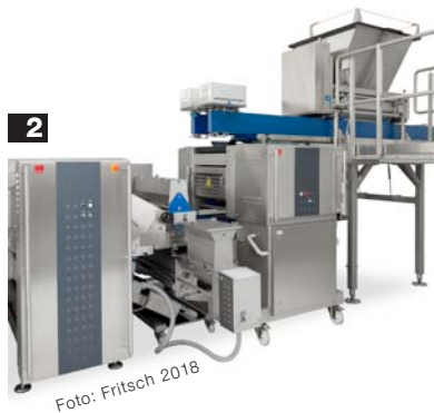
1 Die Impresa Bread hat Fritsch für die industrielle Brotherstellung mit hohen Stückzahlen von Toast, Ciabatta, Baguette und mehr sowie die Verarbeitung von weichen Teigen entwickelt. 2 Erstes Modul der Linie ist der Teigbandformer mit einem patentierten Fünf-Walzen-Ausformsystem, der ohne flüssige Trennmittel wie Öl arbeitet.
