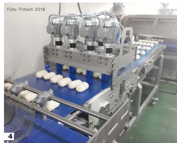
3 Der Wickler der Impresa Bread arbeitet mit gegen- oder mitlaufenden Wirkbändern, die zum Reinigen hochklappbar sind. Für eng gewickelte Produkte gibt es eine Kalibrierwalze. 4 Eine Besonderheit der Linie ist die Toastbrotherstellung nach der hauseigenen 6-Pieces-Methode von Fritsch. Damit sind bis zu 340 Millimeter lange Toastbrote möglich.
